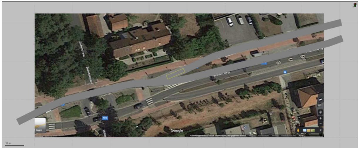
Figuur 23: Screenshot uit Vissim met aanduiding van de reduced speed area
