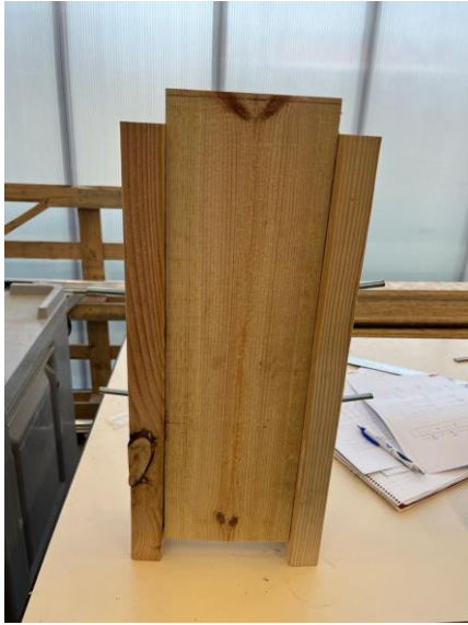
Figuur 43: Proefstuk B-M2 na monotone test met a) Voorzijde b) zijkant (kooideffect)
