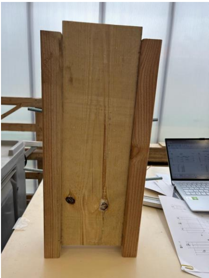
Figuur 44: Proefstuk B-M3 na monotone test met a) Voorzijde b) zijkant
