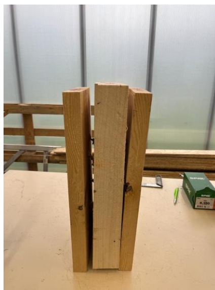
Figuur 67: Configuratie SX na het uitvoeren van de cyclische test
