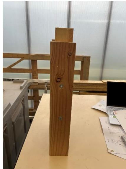
Figuur 46: Proefstuk S-M1 na monotone test met a) element a b) element c
