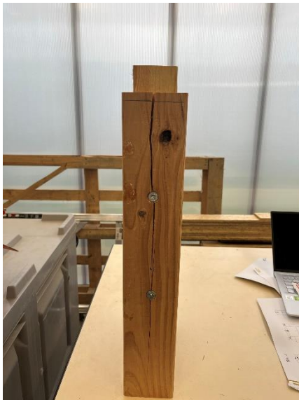
Figuur 46: Proefstuk S-M1 na monotone test met a) element a b) element c
