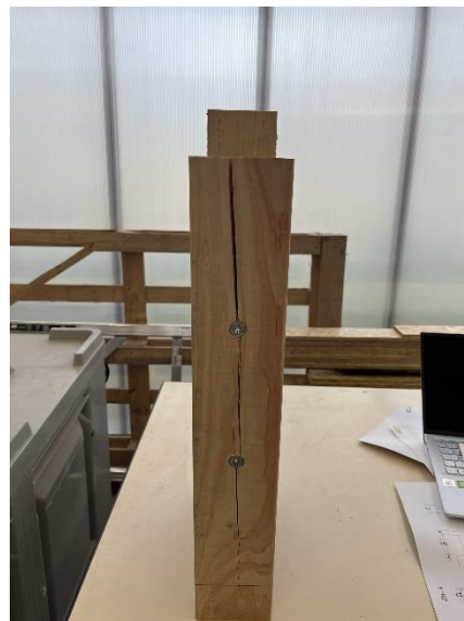
Figuur 47: Proefstuk S-M2 na monotone test met a) element a b) element c
