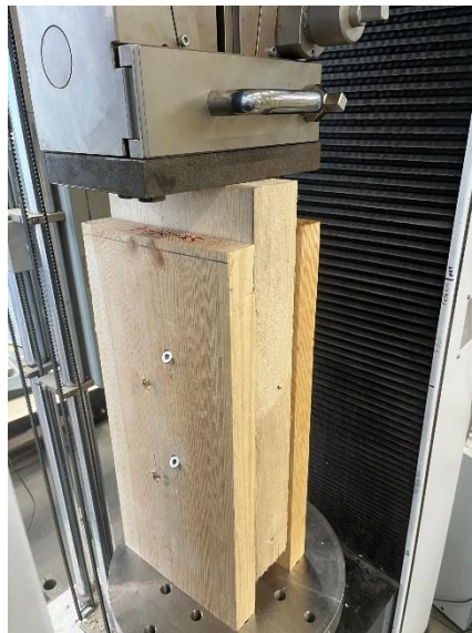
Figuur 58: Opstelling gekruiste schroeven onder drukmachine
