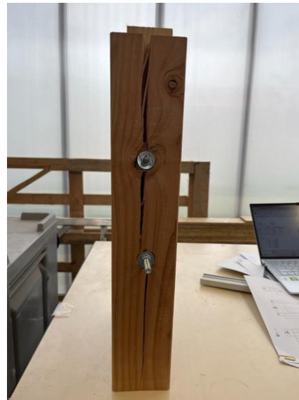
Figuur 44: Proefstuk B-M3 na monotone test met a) Voorzijde b) zijkant
