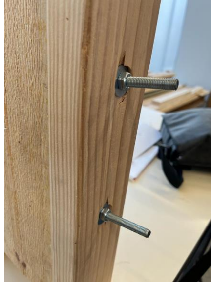
Figuur 43: Proefstuk B-M2 na monotone test met a) Voorzijde b) zijkant (kooideffect)
