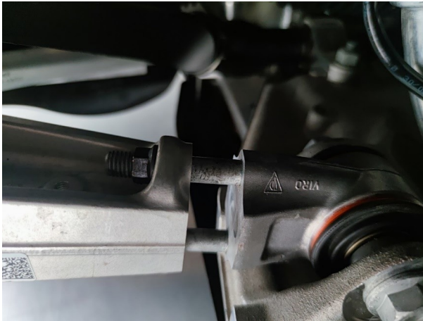
(a) Plaats shims in onderste wishbone
