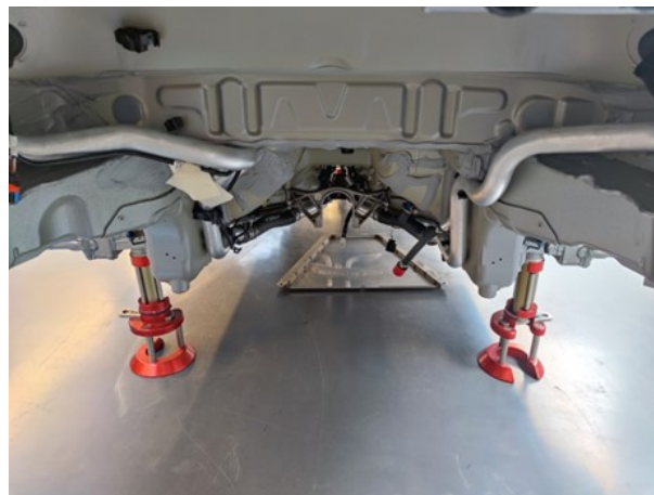
Figuur 4.2: Pneumatische krik en safety's
