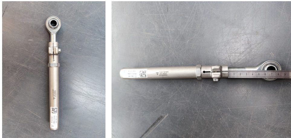
(a) Spoorstang op minimale lengte
