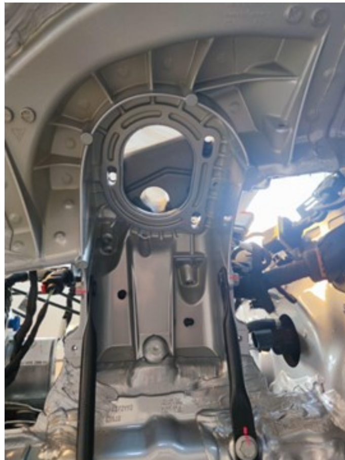
Figuur 2.10: Sleufgaten bevestiging bovenkant demper
