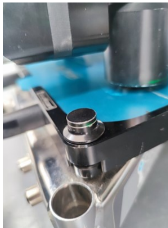
Figuur 4.4: Groene laser op zilveren streepje van scale
