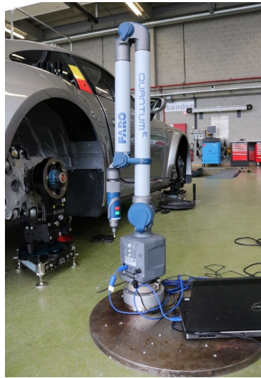
Figuur 3.7: Opstelling meting hardpoints met Faro QuantumE robotarm [32]
