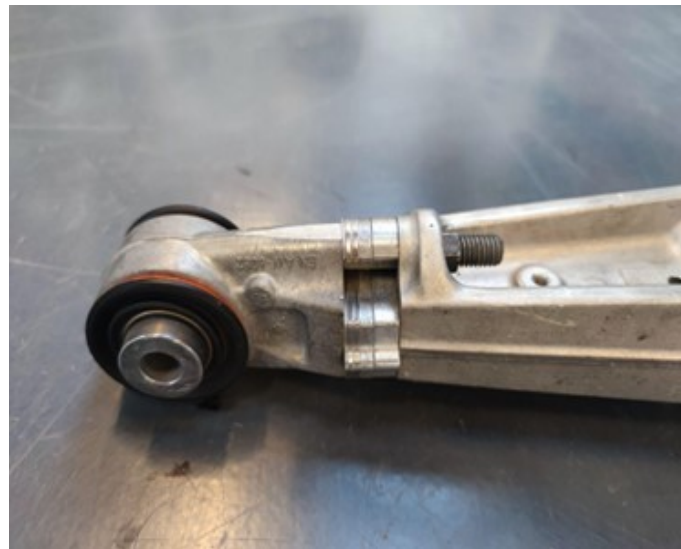
Figuur 2.8: Spacers onderste wishbone
