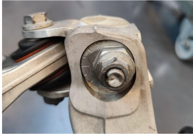
Figuur 2.9: Excentrische bout camber
