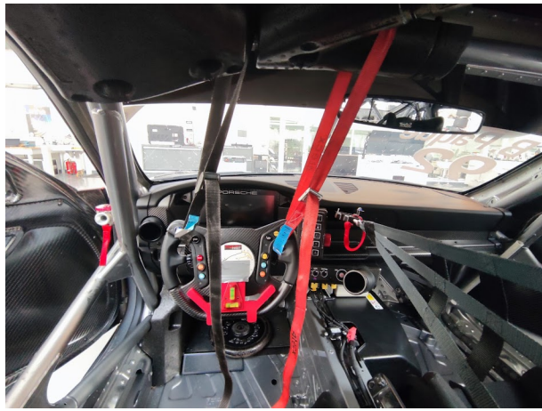
Figuur 4.3: Stuur waterpas en aan rolkooi bevestigd
