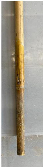
Figuur 61: Aantasting proefstukken na implementatie in beton 1
