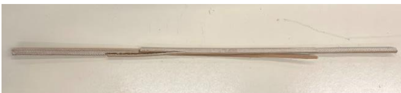
Figuur 46: Longitudinaal falen van de bamboestrip
