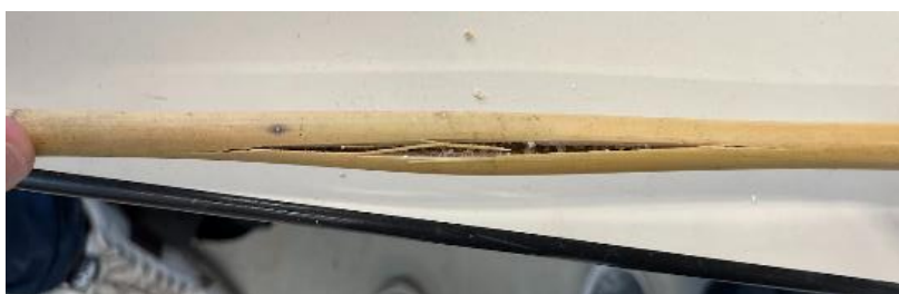
Figuur 65: Splinging proefstukken in de langsrichting
