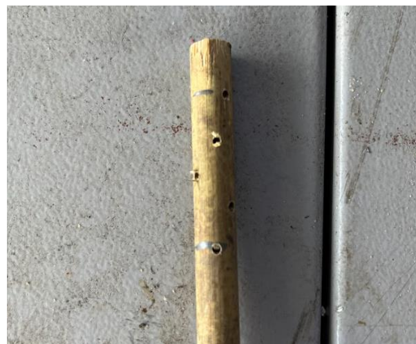
Figuur 18: Proefstuk met geboorde gaten
