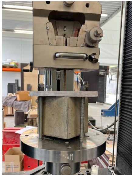
Figuur 28: Proefopstelling uittrekproef labo
