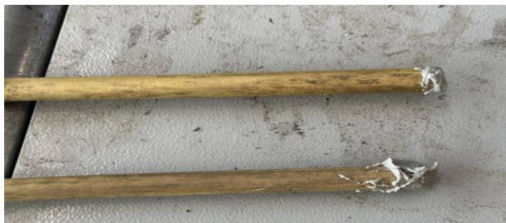
Figuur 15: Proefstukken gevuld met epoxy
