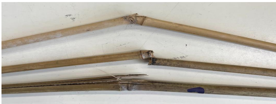
Figuur 67: Falen van de knopen bij buigproef
