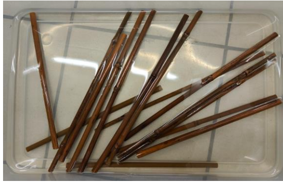
Figuur 30: Proefstukken vochtabsorptie in een waterbak
