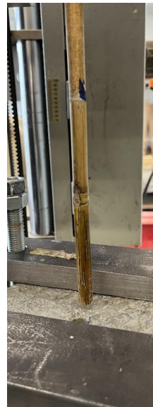
Figuur 62: Aantasting proefstukken na implementatie in beton 2
