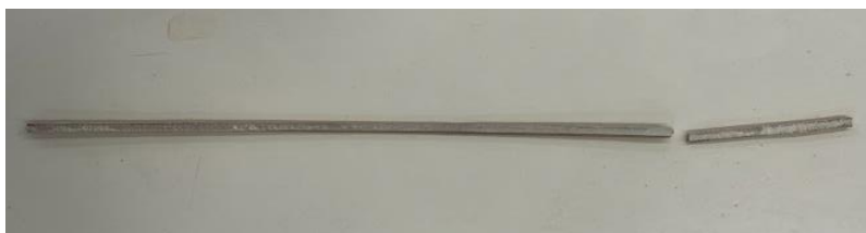
Figuur 45: Falen van bamboestrip aan inklemming grip
