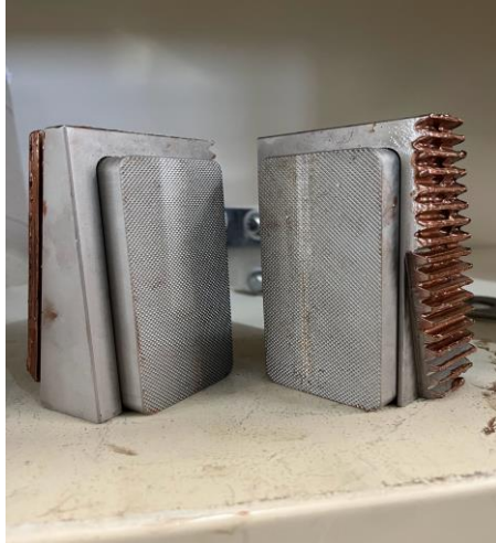
Figuur 26: Platte grips voor bamboestrips
