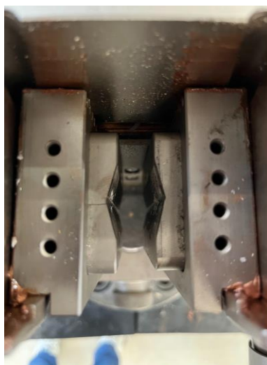
Figuur 14: Hulpstukken ter inklemming van de proefstukken
