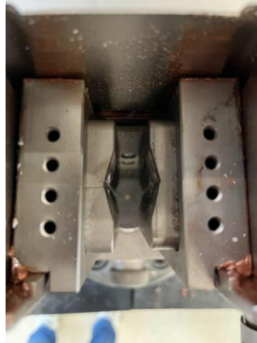
Figuur 27: V-vormige grips voor staalwapening
