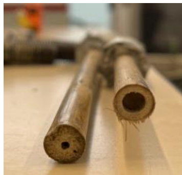
Figuur 63: Verschil in opbouw tussen bamboestok en knoop
