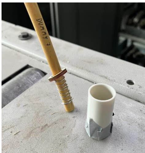
Figuur 17: Proefstuk versterkt met staaldraad
