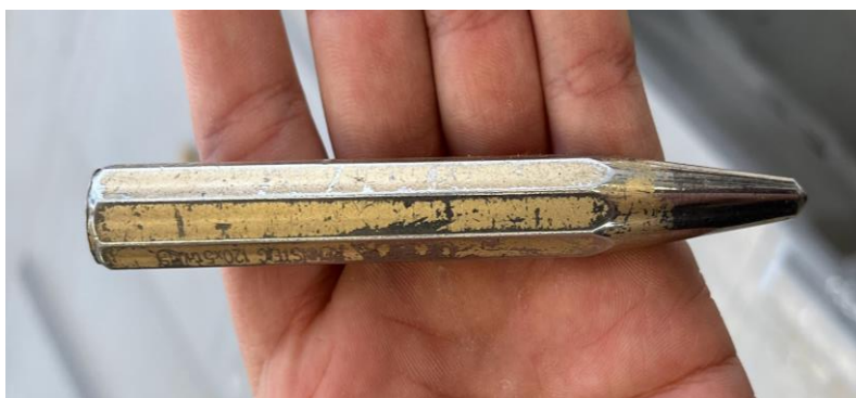
Figuur 19: Gebruikte centerpons om de bamboestokken te splijten
