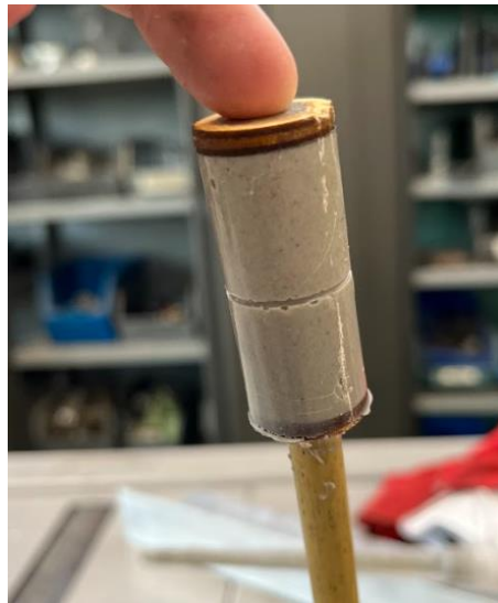
Figuur 16: Uitwendige cilinder van epoxy rond proefstuk
