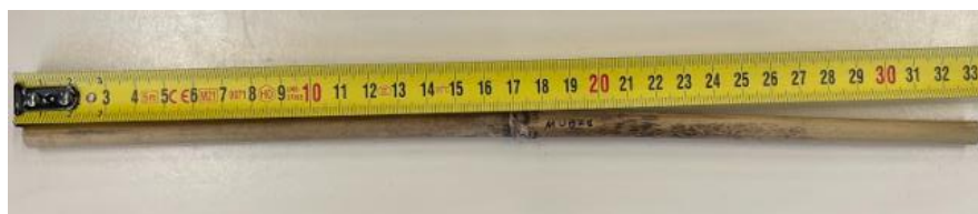
Figuur 22: Proefstuk uittrekproef zonder knoop in het beton
