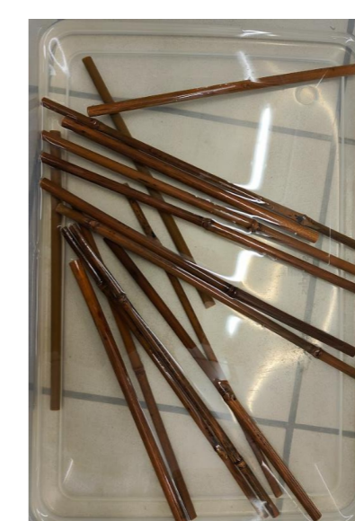
Fig. 5: Ondergedompelde proefstukken in een waterbak
