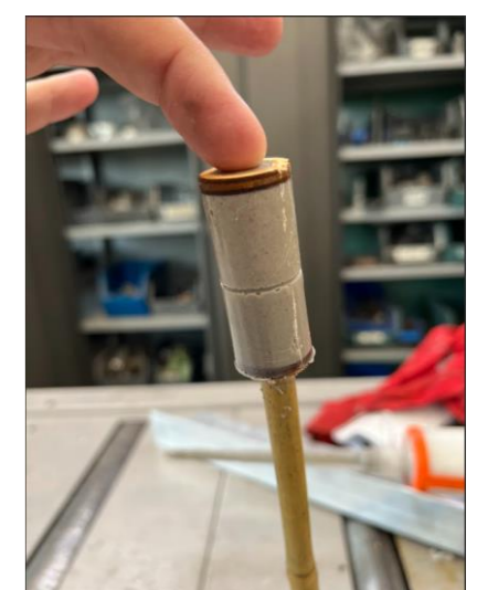
Fig. 1: Eindverankering met epoxy
