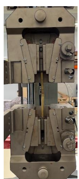
Fig. 2: Proefstuk trekproef in trekbank
