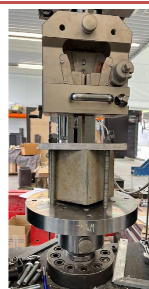
Fig. 4: Proefstuk uittrekproef in trekbank
