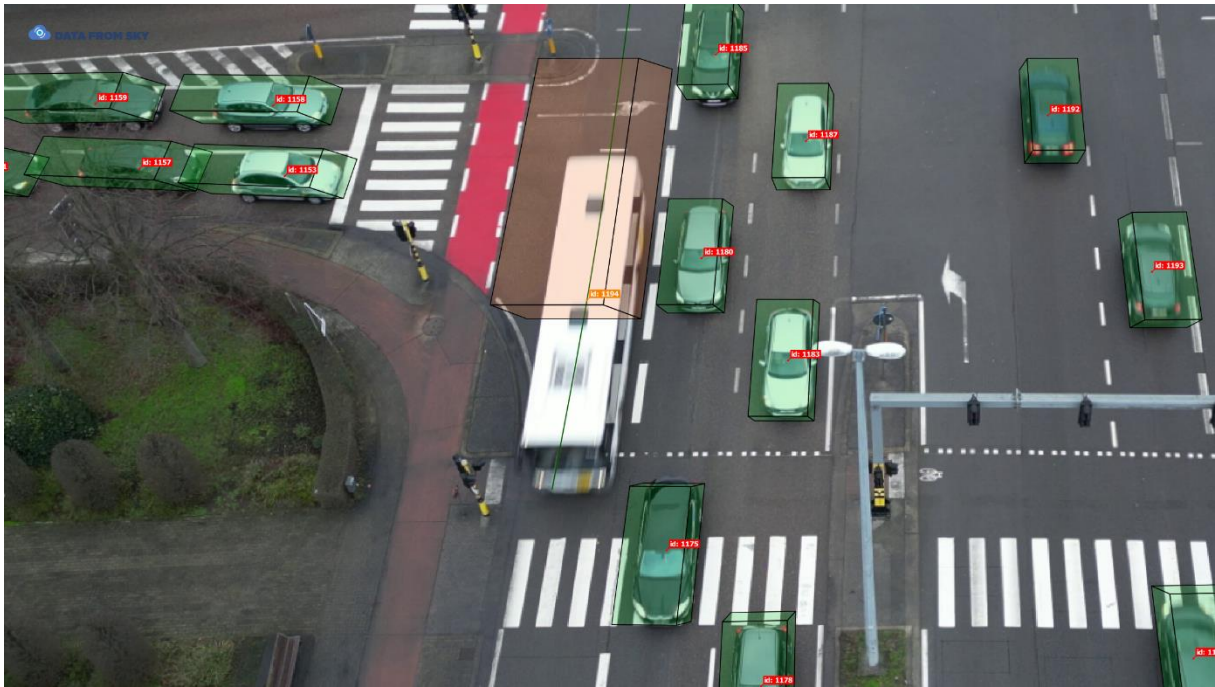
Figuur 37 Conflictsituatie op basis van de PET-parameter tussen een rijdende bus op de busbaan en stilstaand verkeer op de reguliere rijweg.
