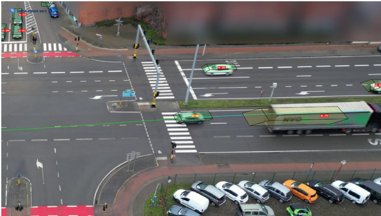
Figuur 33 Voorbeeld van een "kritieke" situatie op basis van de TTC-parameter waarbij een wagen van rijstrook verandert om een vrachtwagen in te halen.
