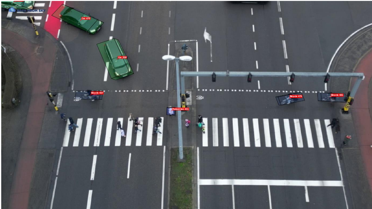
Figuur 25 Detectie van voetgangers en fietsers tijdens het oversteken van de Kempische Steenweg rond de start van de schooldag.
