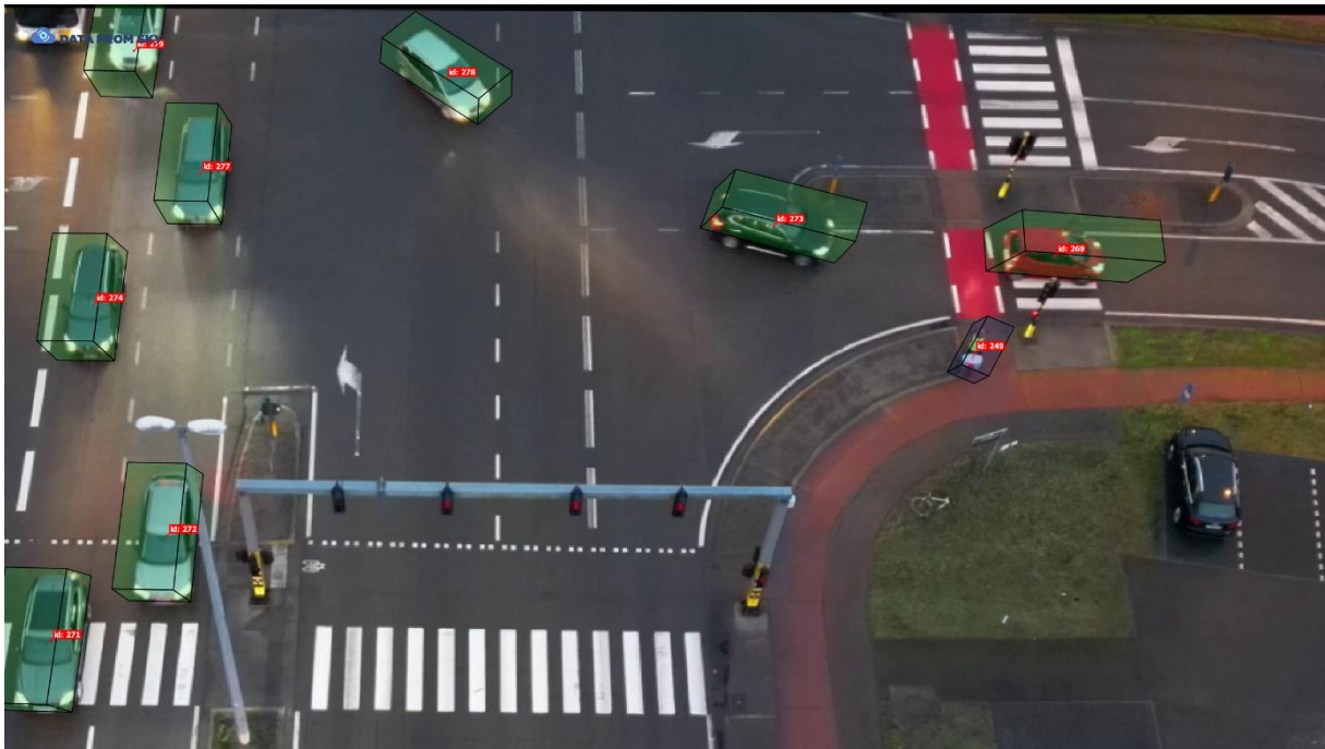
Figuur 35 Voorbeeld van een situatie waarbij afslaande wagens een conflict veroorzaken met een wachtende fietser op basis van de TTC-parameter.
