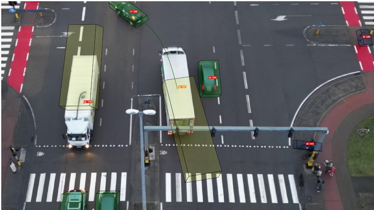
Figuur 38 Conflictsituatie op basis van de PET-parameter tussen een afslaan vrachtwagen met een foutieve bounding box en een wagen die rechtdoor rijdt.
