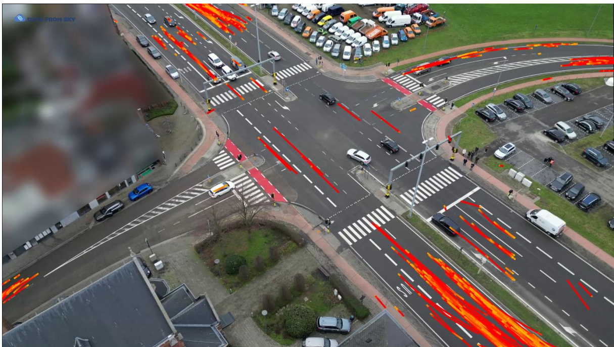
Figuur B15 Overzicht van alle momenten waarop weggebruikers tijdens vlucht 6 sterk afremmen.
