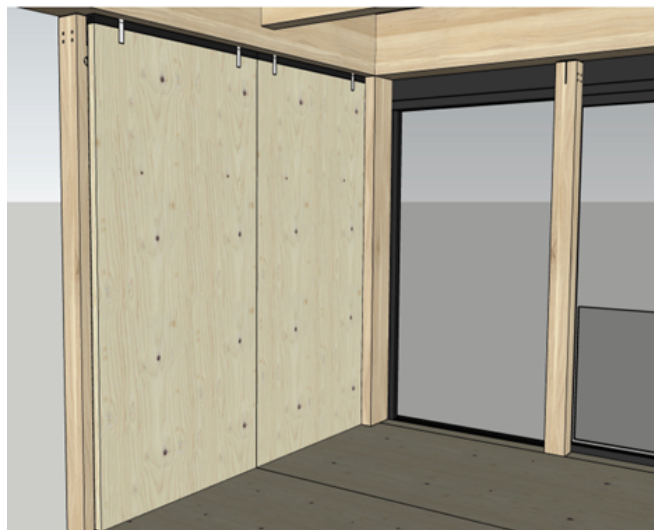
Figuur 2.2: CircuWallPanels op paal- en balkstructuur [1]
