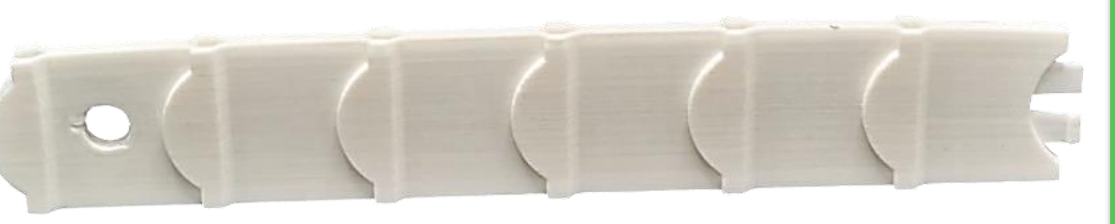
Figuur 7: Modulaire balk van dubbele cantilever ge-3D-print met ABS
