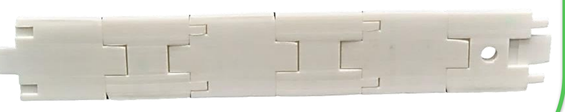
Figuur 8: Modulaire balk van enkele cantilever ge-3D-print met ABS
