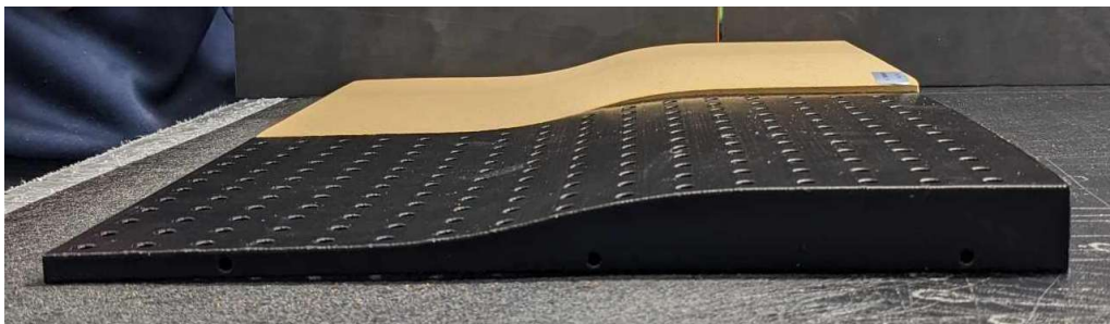
Figuur 70: Hoogteverschil prototype 1 t.o.v. freesblok
