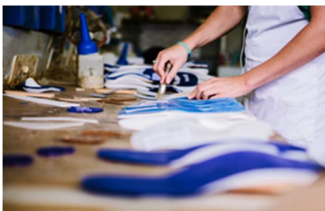
Figuur 6: Lijmen van de bekleding [3]
