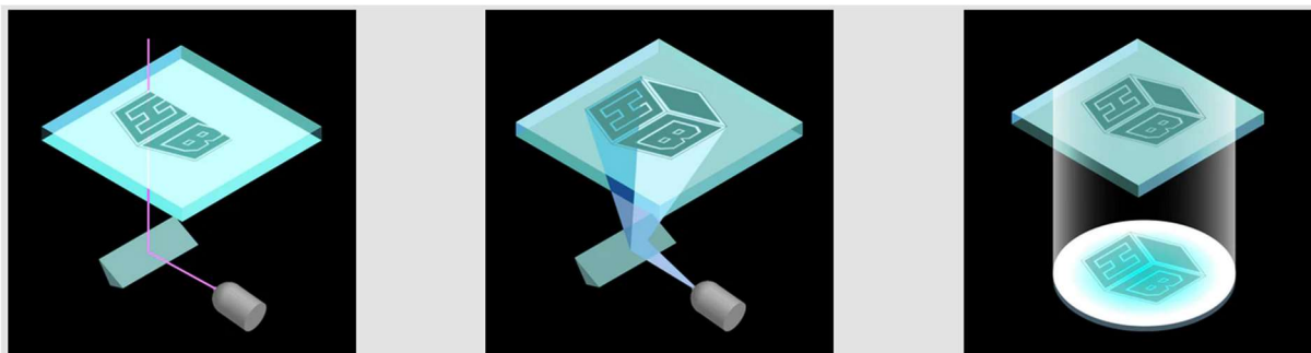
Figuur 17: Werking van een SLA, DLP en LCD-printer in volgorde [26]
