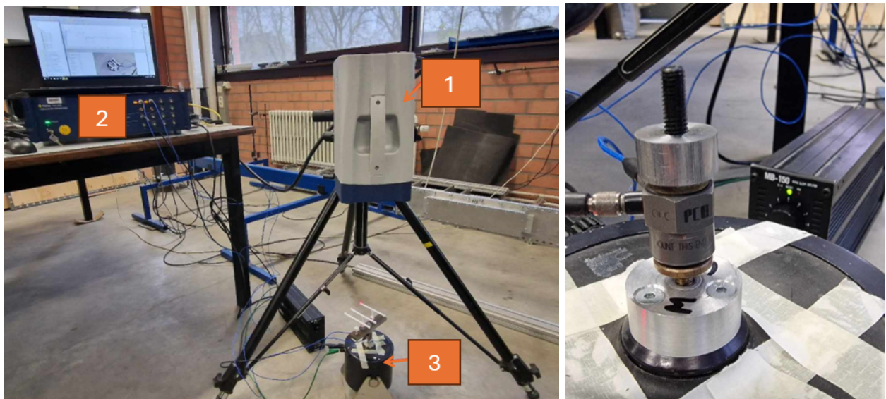
(a) 1. laservibrometer, 2. SCADAS met laptop, 3. shaker
