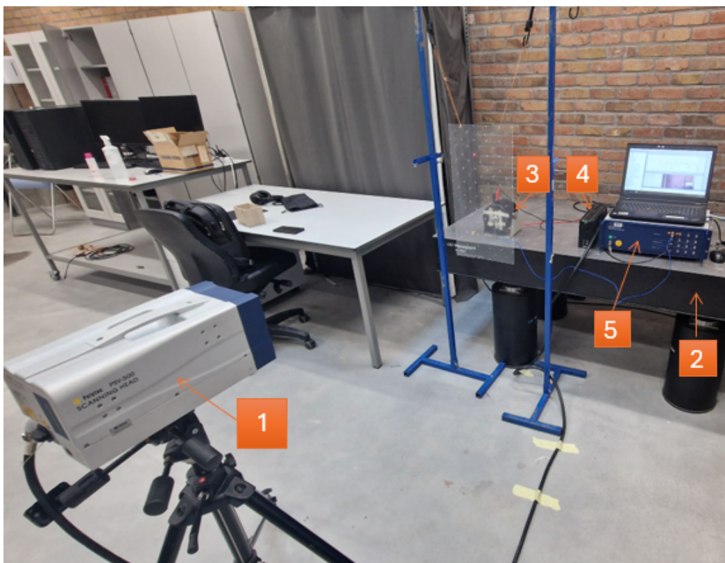
Figuur 5.5: Meetopstelling: 1. Laservibrometer, 2. Tafel, 3. Shaker, 4. Versterker, 5. SCADAS met laptop
