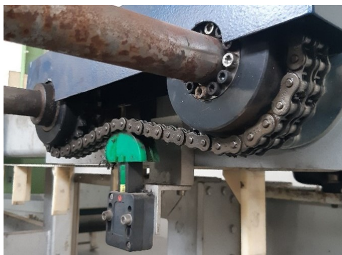
Figuur 2.8: Systeem voor het opspannen van de ketting in de ingangsbuffer
