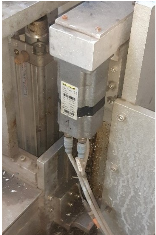
Figuur 2.12: Motorsysteem voor het instellen van een aanslag in de aanvoer
