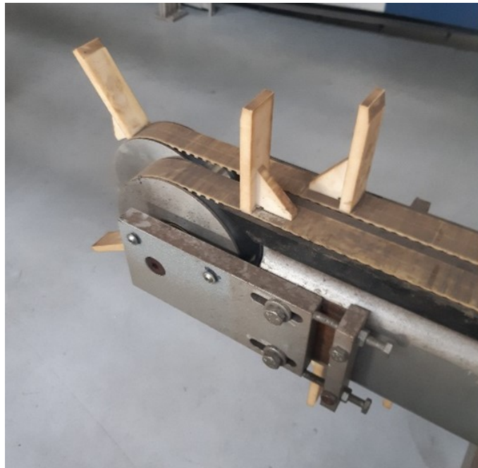
Figuur 2.5: Systeem gebruikt voor het opspannen van de riemen bij optreden rek
