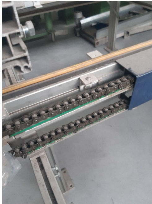
Figuur 2.22: Riemen voor het transporteren van de profielen in de uitgangsbuffer
