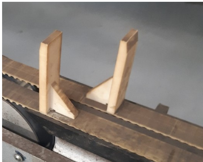
Figuur 2.6: Systeem voor het inklemmen van de profielen in de ingangsbuffer
