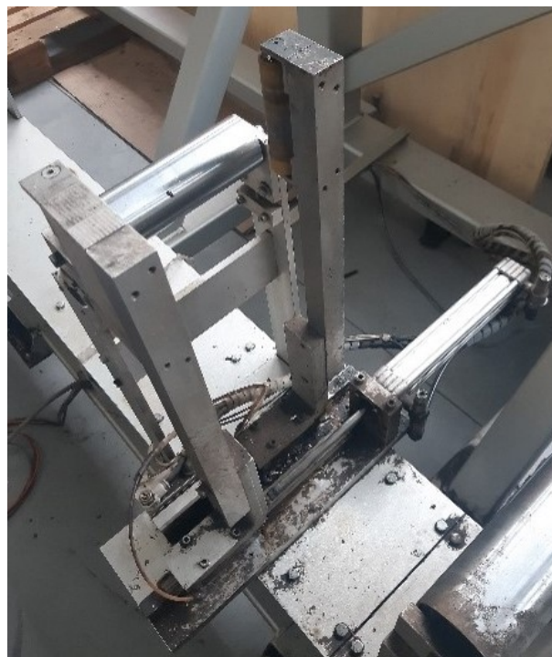
Figuur 2.13: Mechanisme voor het positioneren van de profielen in de breedte
