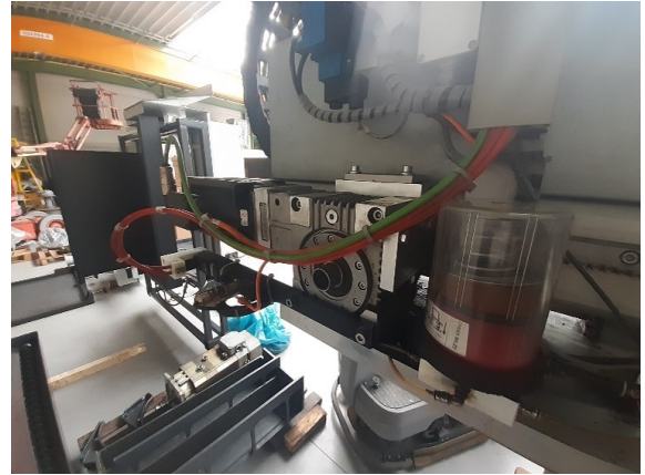
Figuur 2.15: Motor, gearbox en tandwiel opstelling
