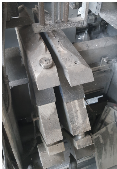
Figuur 2.18: Instelbare aanslagen gebruikt in de zaagmachine
