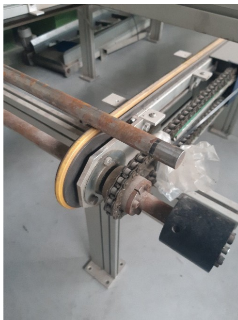
Figuur 2.23: Mechanisme gebruikt voor het ophangen van de riemen
