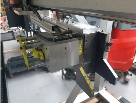
Figuur 2.14: Mechanisme voor het vastklemmen van de profielen in de aanvoer
