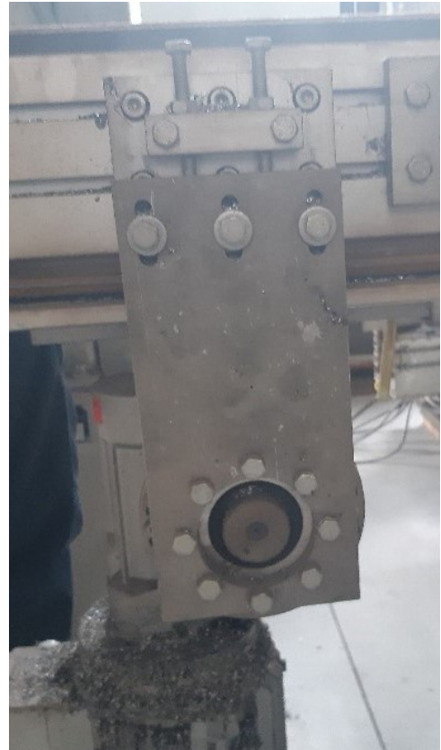
Figuur 2.25: Systeem voor het aanspannen van de ketting in de uitgangsbuffer
