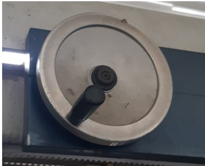
Figuur 2.7: Systeem voor het instellen van de inklemming in de ingangsbuffer
