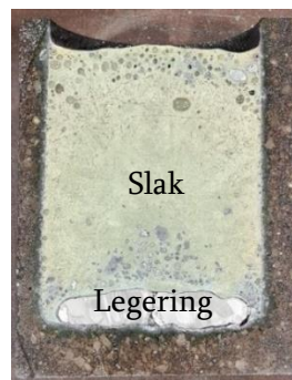
Figuur 2: Doorsnede van een kroes met black mass na pyrometallurgische scheiding
