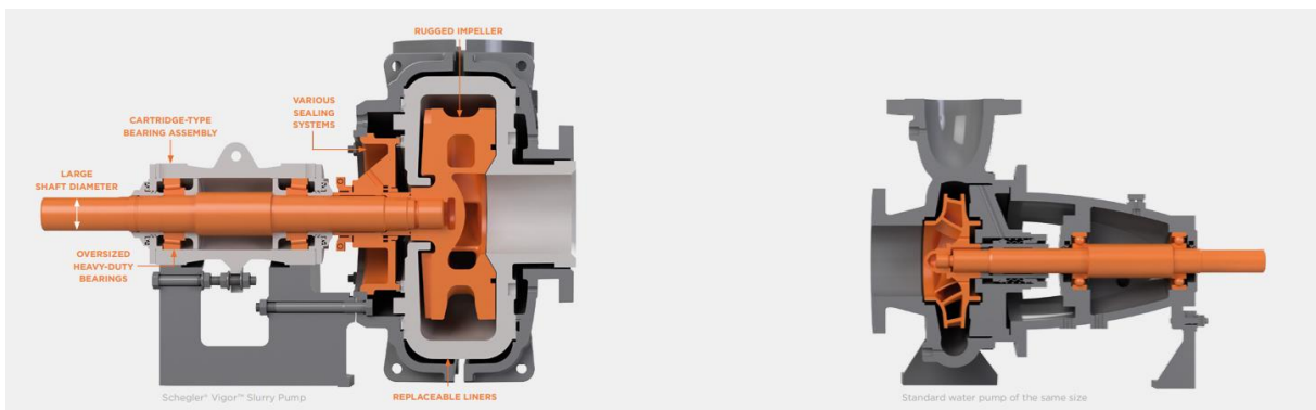
Figuur 15: Slurrypomp (links) en een waterpomp (rechts) van gelijke grootte [17]
