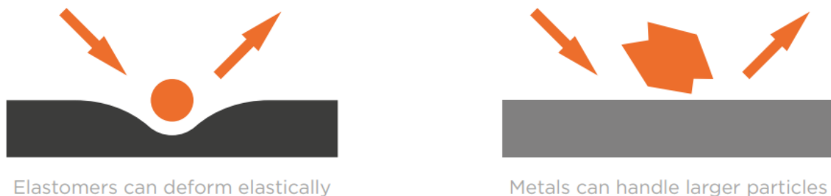
Figuur 35: Werkingsprincipe liners, elastomeren (links) en metalen (rechts) [17]
