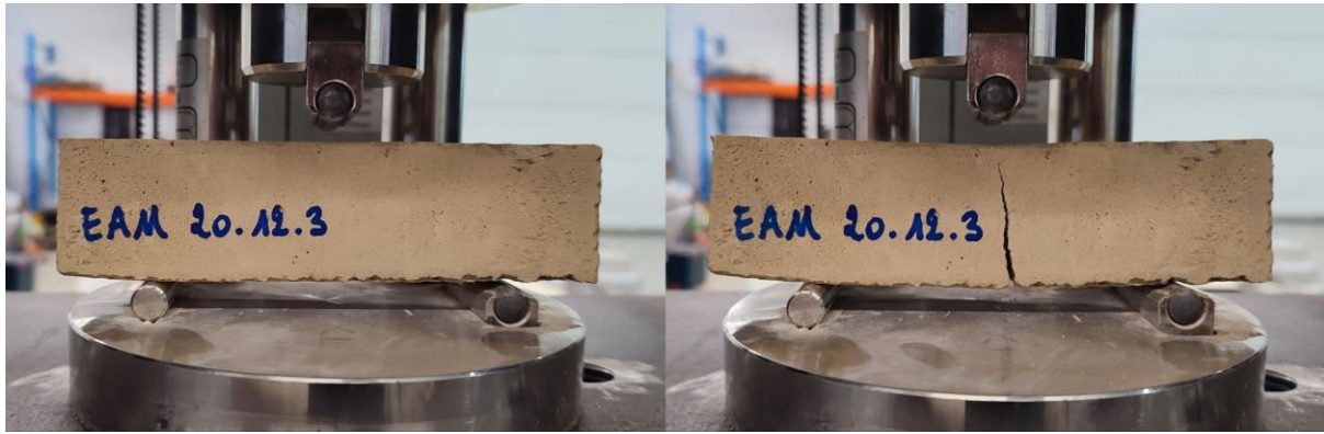
Figuur 25: Voorbeeld driepuntsbuigproef mortelbalkje
