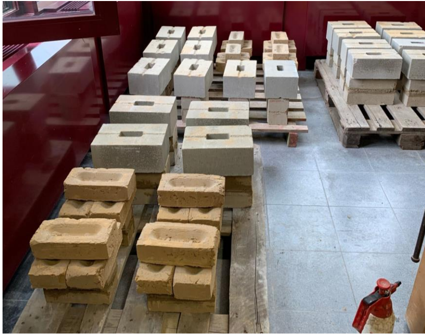
Figuur 22: Gemetste coupletten met voorbelasting
