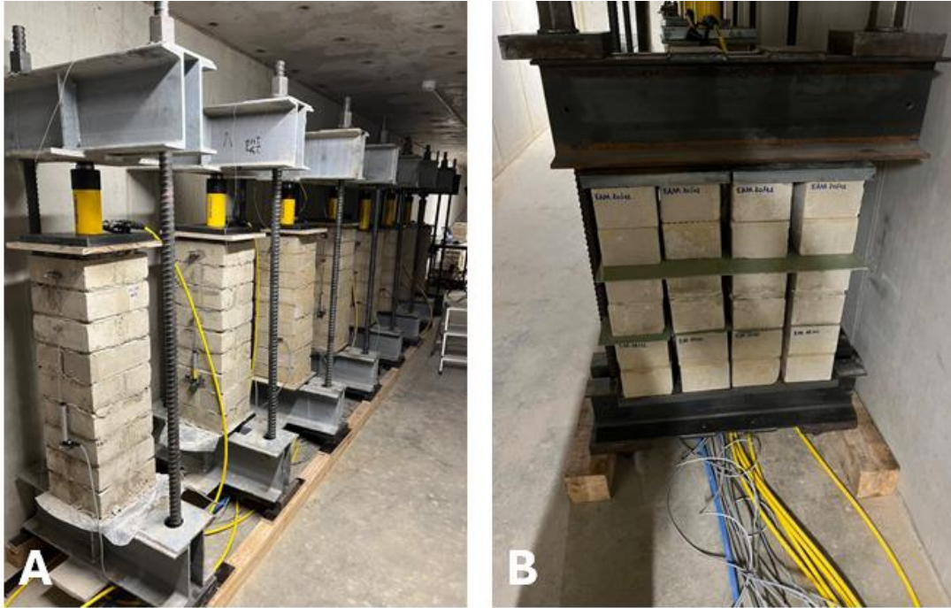
Figuur 19: Langdurige belasting a) zuiltjes b) coupletten
