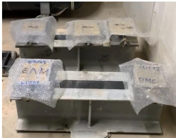
Figuur 24: Droging mortelbalkjes
