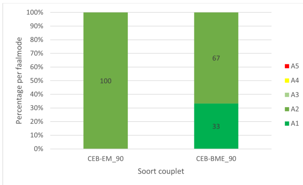
Figuur 58: Faalmodi coupletten na langdurige belasting
