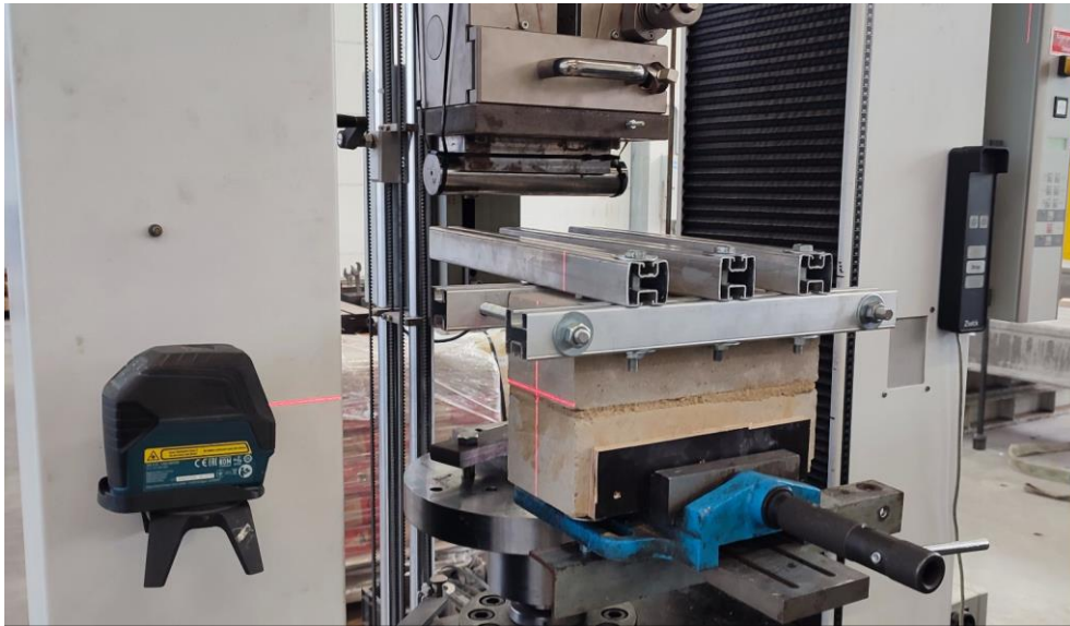
Figuur 11: Vernieuwde automatische bond wrench-test
