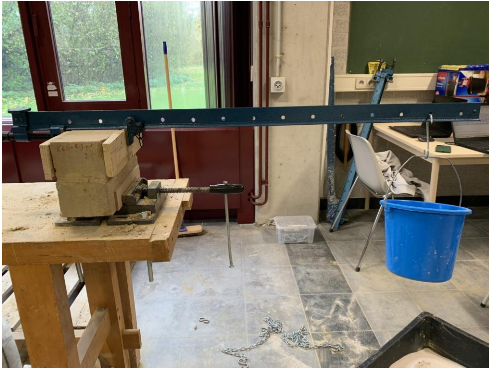
Figuur 9: Proefopstelling bond wrench-test exploratiefase
