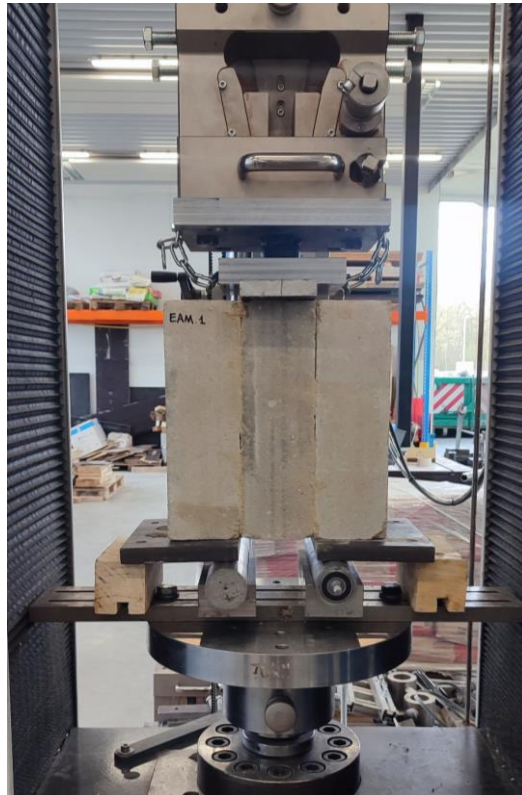
Figuur 16: Proefopstelling schuifsterketest
