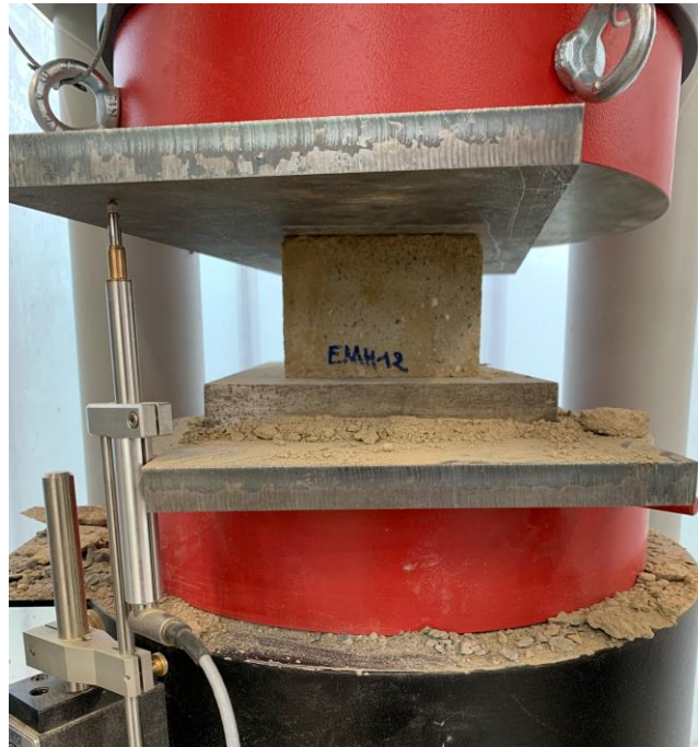
Figuur 18: Proefopstelling drukproeven met behulp van de verplaatsingsmeter
