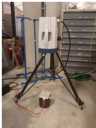
Figuur 21: Opmeting van resonatoren met een laservibrometer
