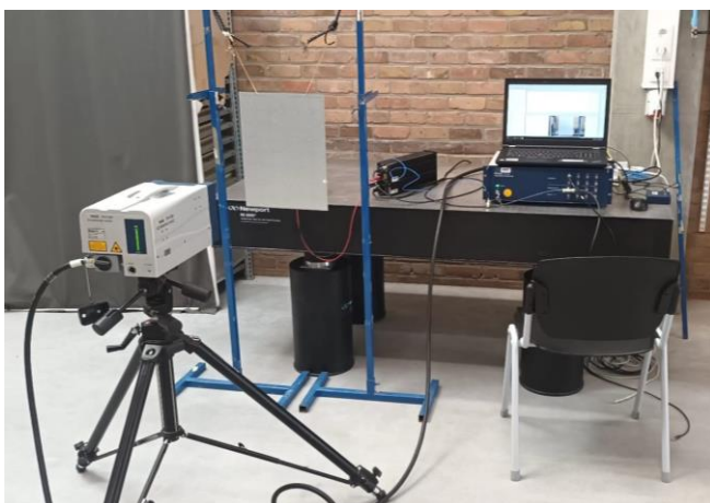
Figuur 32: Opmeten van de lege basisstructuur
