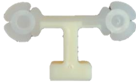
Figuur 31: Resonator m.b.v. parameteroptimalisatie
