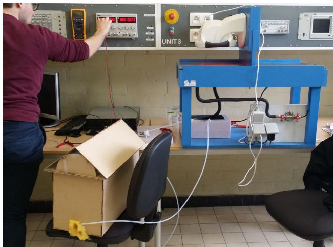
Figuur 4: Maquette en regeling van een huis verwarmd met zonneboiler door een multidisciplinair lerarenteam, voorbeeld uit de leermodule ontworpen in STEM@school rond het thema 'woningbouw'.
