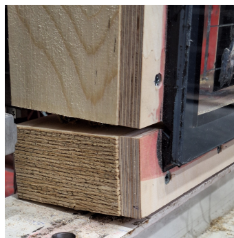
Figuur 3.10: Falen van de schroefverbinding door opwaartse verplaatsing proefstuk K-SG-P
