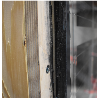
Figuur 3.9: Adhesief falen van proefstuk D-FBG-P
