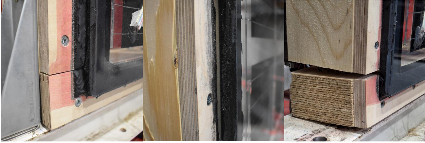
Figuur 3: Faalmechanismen proefstukken
