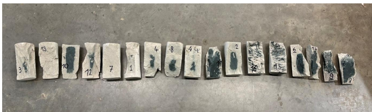
Figuur 29: Gebroken groutkernen geordend volgens druksterkte
