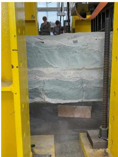
Figuur 46: Scheurvorming en falen proefstuk 2A (3)
