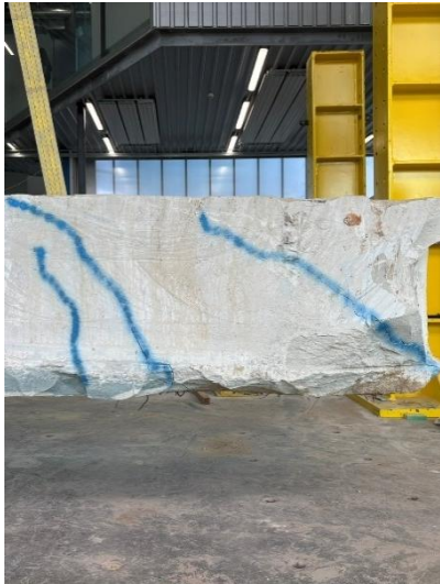
Figuur 50: Scheurvorming en falen proefstuk 2B (1)
