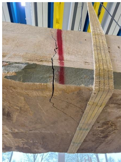
Figuur 45: Scheurvorming en falen proefstuk 2A (2)
