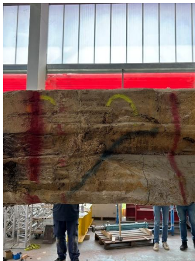
Figuur 52: Scheurvorming en falen proefstuk 2B (3)
