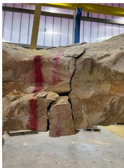
Figuur 41: Scheurvorming en falen proefstuk 1B (4)
