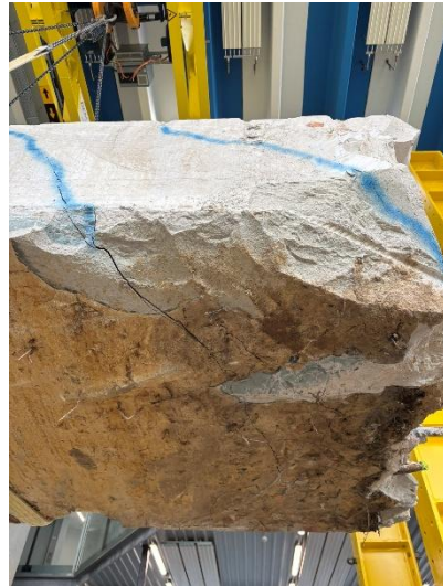
Figuur 51: Scheurvorming en falen proefstuk 2B (2)
