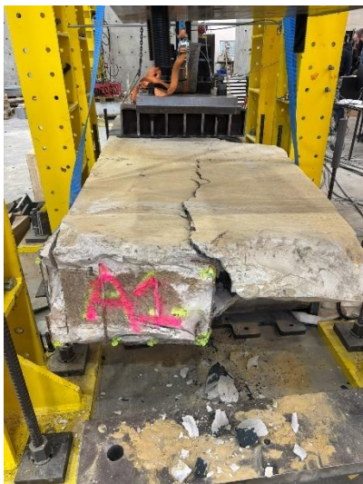
Figuur 38: Scheurvorming en falen proefstuk 1B (1)
