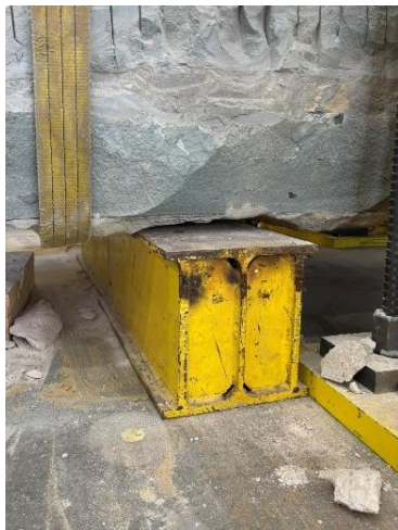
Figuur 20: Scharnierende oplegging
