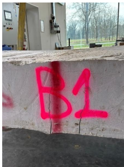
Figuur 35: Scheurvorming en falen proefstuk 1A (2)
