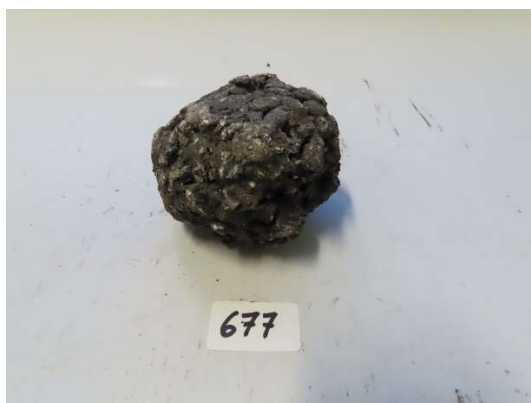
Figuur 4: Proefstuk voor Cantabro proef, voor en na het uitvoeren van de proef
