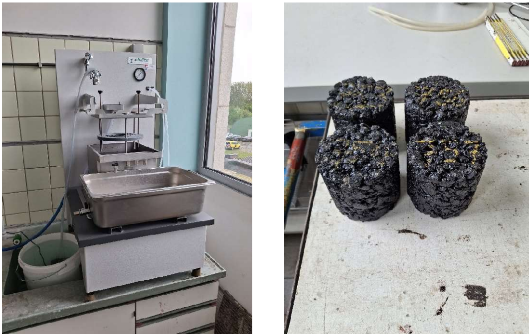
Figuur 5: proefopstelling voor verticale permeabiliteit en voorbeeld proefstukken
