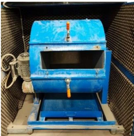
Figuur 3: Abrasion drum gebruikt voor Cantabro proef
