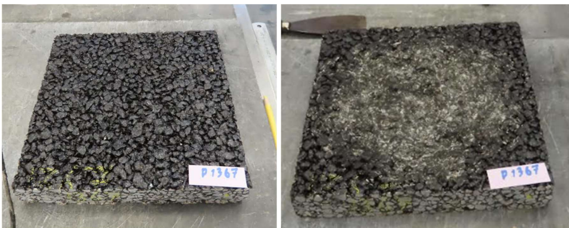
Figuur 7: Voorbeeld proefstuk rafelingsplaat, voor en na het uitvoeren van de rafelingsproef met DSD rafelingstester
