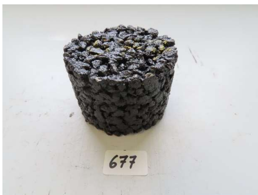
Figuur 4: Proefstuk voor Cantabro proef, voor en na het uitvoeren van de proef
