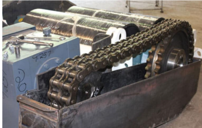
Figuur 5.21: Motorreductor met kettingaandrijving [43]
