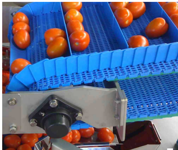
Figuur 5.10: Modulaire kunststof schakelband [26]
