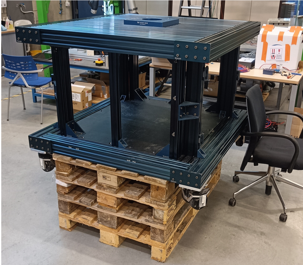
Figuur 3.19: Vention platform met KELO-drives gemonteerd
