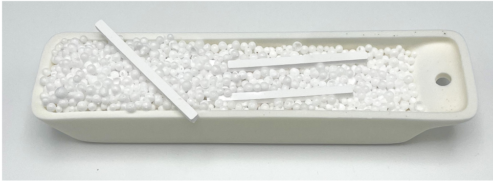
Figuur 3.7: Aluminiumoxide-kroesje met poreus aluminiumoxide
