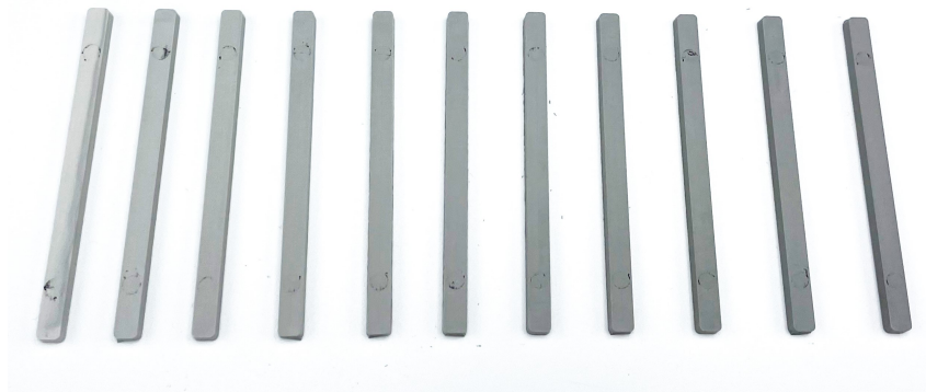
Figuur 4.5: Visuele vergelijking tussen de verschillende recyclagestappen
