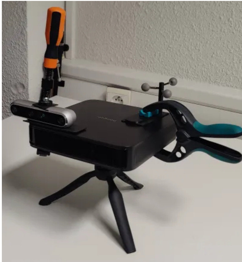
Figuur 3.5: Het projector-camerasysteem met retro-reflectieve markers voor tracking met een motion-capturesysteem.
