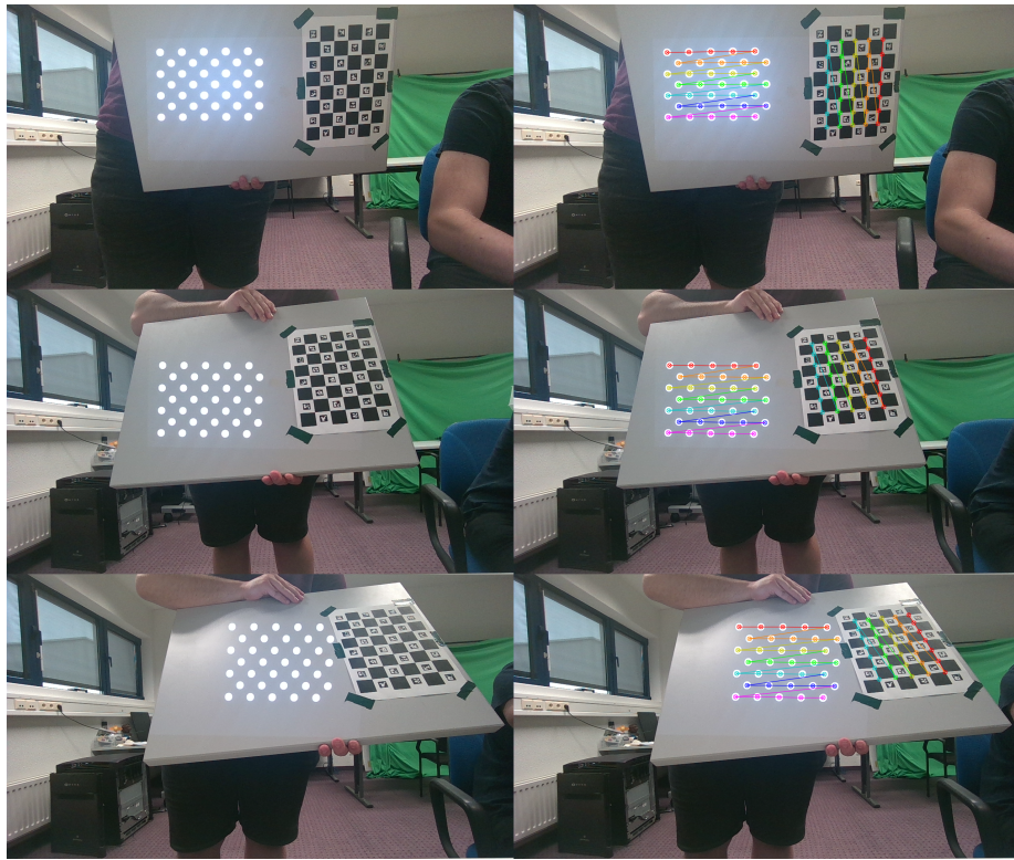
Figuur 4.6: Voorbeeldopstelling voor projector-camera-kalibratie met een kalibratiebord in verschillende poses.
