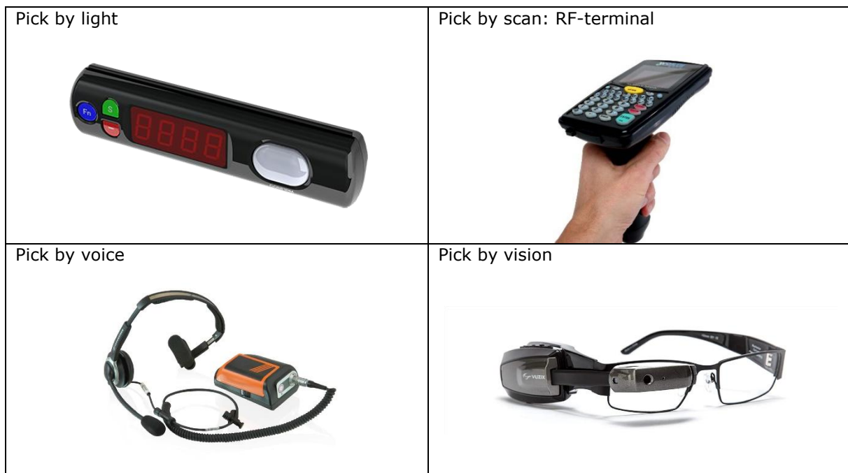
Figuur 17: Overzicht picking tools
