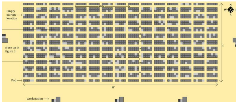
Figuur 8: Bovenaanzicht RMF's (Lamballais et al., 2016)
