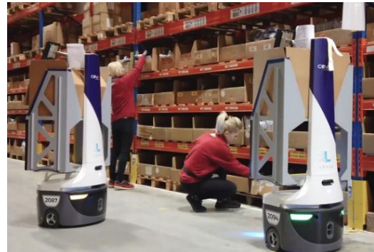
Figuur 19: Samenwerking tussen AMR en orderpicker (OLogic, Inc., 2024)
