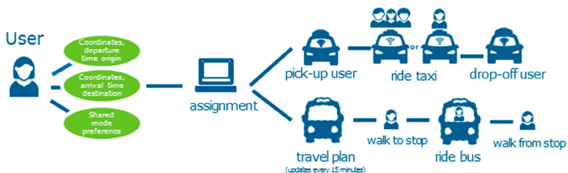
Figuur 6: Simulatiemodel voor gedeeld autonoom vervoer in Lissabon, met taxi- en minibusdiensten (Martinez & Viegas, 2017, p. 18)
