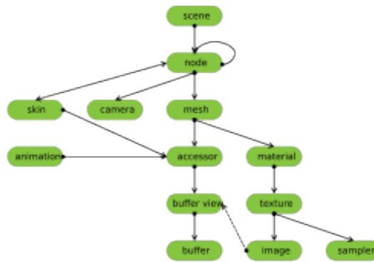
Figuur 2.4: Een schematische voorstelling van hoe een glTF-node in een scène gestructureerd is en welke componenten deze kan bevatten. Figuur overgenomen uit de glTF 2.0-specificatie van de Khronos Group [22].
