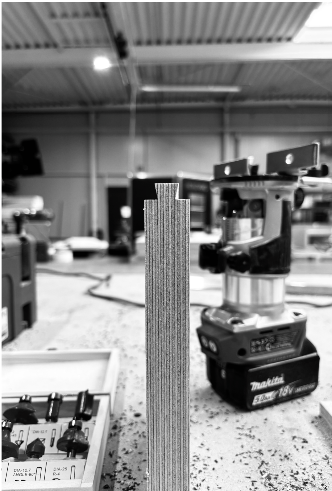
Afb. 190, Zwaluwstaartverbinding experiment in het atelier
