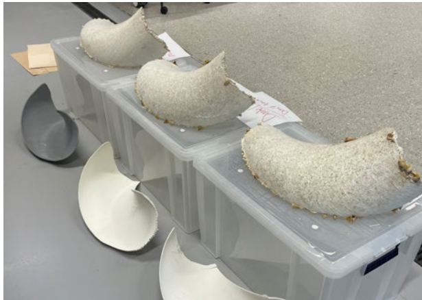
Mycelium wind turbine blades, Växjö, June 2023
