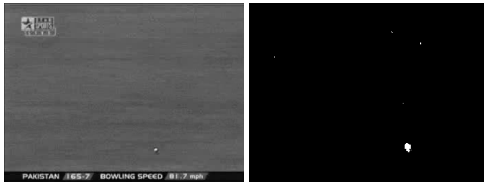
Figuur 3.7: Een voorbeeld van een binair masker (rechts), bekomen door statistische analyse van een temporele wavelet transformatie op het originele beeld (links) [67].
