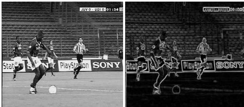
Figuur 3.3: Een tweedimensionale wavelet transformatie van een televisiebeeld geeft de gradiënten van het beeld weer. Figuur uit [8]
