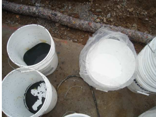
Foto 13: Twee componenten van RegenOx™: Part A vast alkalisch oxidans en Part B vloeibare activator
