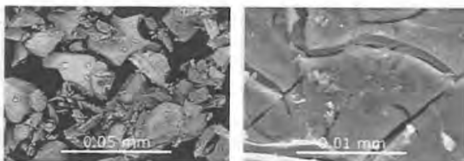
Fig. 3.9 SE-beelden bij verschillende vergrotingen van de acetaat-tartraat-precursor, gedroogd bij 80 °C en gemalen in een mortier. De donkere delen in het rechtse beeld zijn barsten, ontstaan als gevolg van het hoog vacuüm in de specimenruimte.
